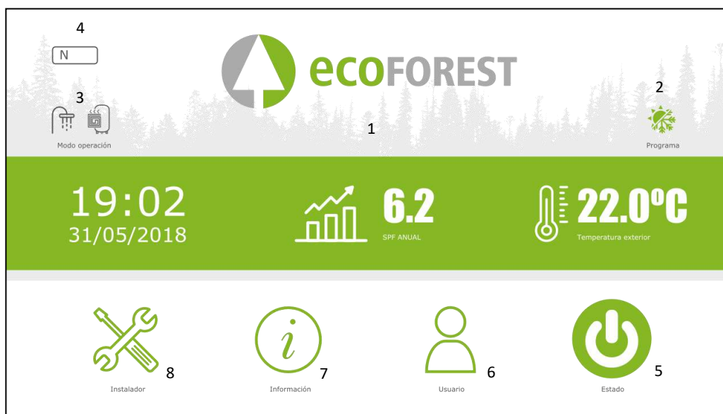
Figura 2.2. Schermata principale dell'interfaccia web EASYNET. Esempio di pompa di calore ECOFOREST.
