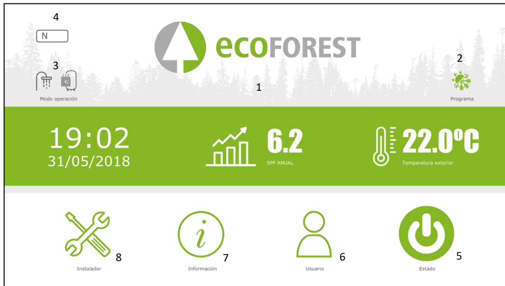
Abbildung 2.2 Hauptbildschirm des Webinterface EASYNET. Beispiel ECOFOREST-Wärmepumpe.
