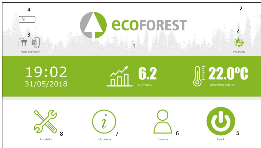
Figure 2.2. Écran principal de l'interface web EASYNET. Exemple de pompe à chaleur ECOFOREST.
